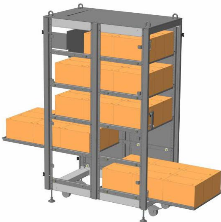
Рис.2 Расположение АБ в шкафу
