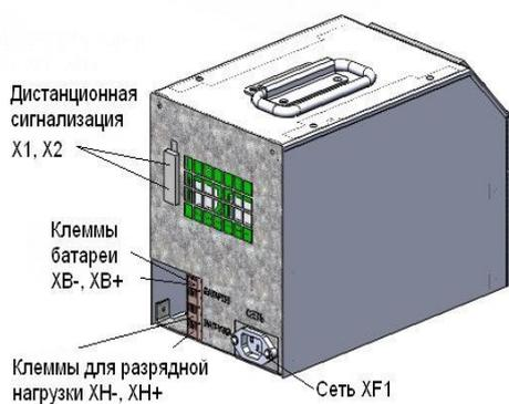
Рисунок 9.1 - Подключение УКРЗА-В-7
